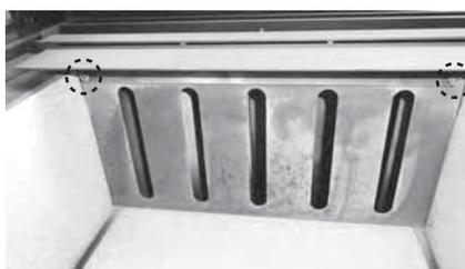
左右2箇所のボルトを外します。
